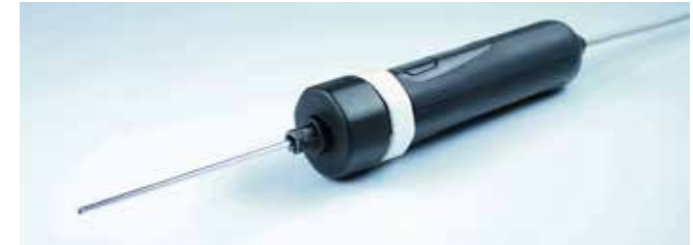
Einweg-Endoskop mit integrierter Opto-Elektronik und Sensor im Schaft
