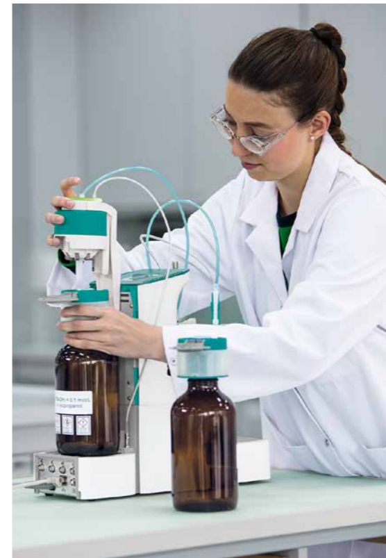
Entwicklung eines Liquid-Adapter-Systems mit integrierter RFID-Technologie
