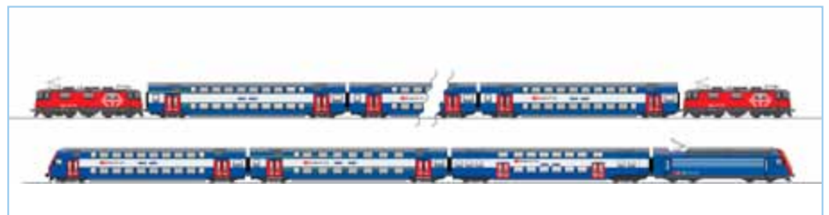
«Refit» der ersten Generation der Doppelstockzüge der S-Bahn Zürich; Integration eines neuen Niederflur-Zwischenwagens (oben) und Doppelstockzug für die Hauptverkehrszeit (unten)
