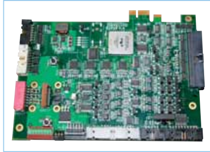
Elektronik für Echtzeit-Bewegungssimulator basierend auf FPGA mit PCIe-Kommunikation (2.5 GHz) und on-board controller (32 bit)
