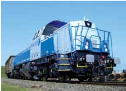
Dieselhydraulische Rangier- und Streckenlok Gravita® 10BB mit 1'200kW Leistung für den lokalen und regionalen Güterverkehr
