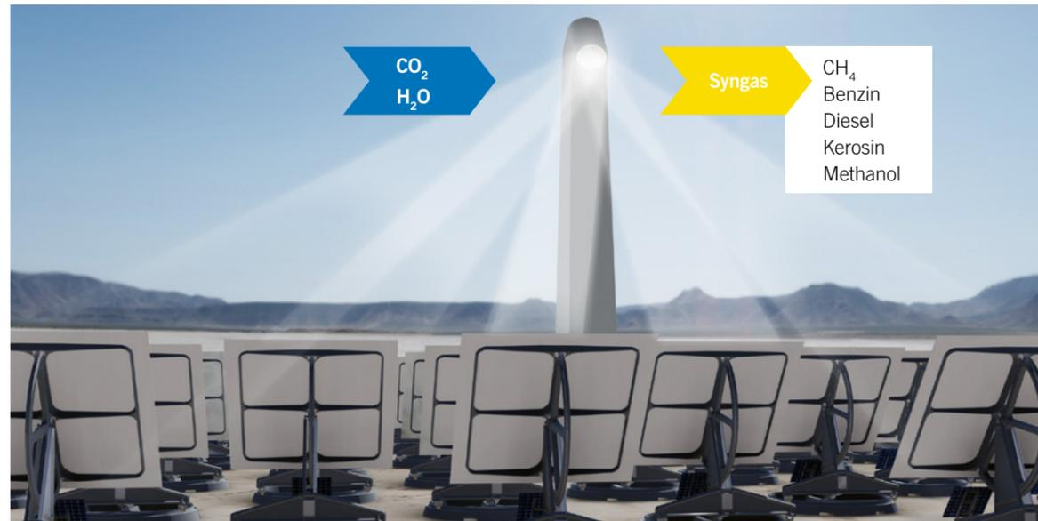
System mit Solarturm, Heliostaten und Receiver im Brennpunkt
